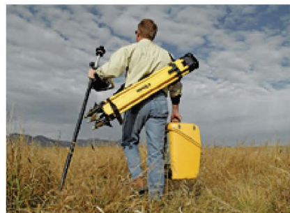
نقشه برداری توپوگرافی - در وضعیت روباتیک، یک فرد به همان سرعتی که راه می‌رود نقاط را اندازه‌گیری و ثبت می‌نماید.
